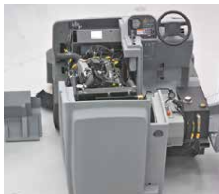
Nilfisks NoTools™-system gör det mycket enkelt att utföra service. Det går att komma åt motor och hydraulik från fem olika håll vilket sparar tid och håller servicekostnaderna nere
