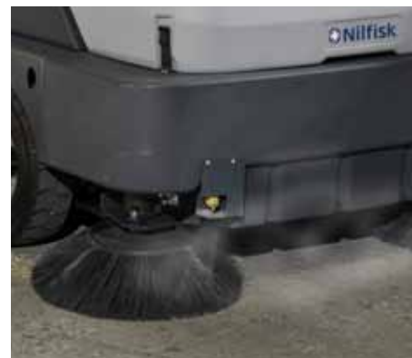
Det unika DustGuard™-systemet håller effektivt allt damm i schack genom att spraya en fin vattendimma över de främre sidoborstarna
