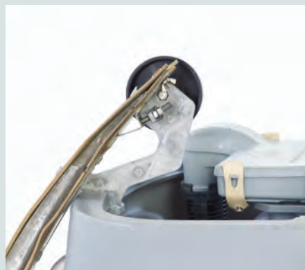
Inbyggt system för upphängning av sugskrapa på smutsvattentanken för enkel genomfart i trånga utrymmen.
