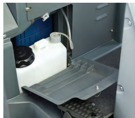
Enkelt att byta rengöringsmedelsdunk, som nu finns under sätet.
